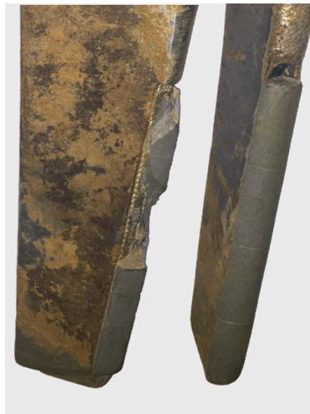
Photos après 200 hectares sur une machine de 4 mètres. Lame adaptable à gauche / Lame KUHN à droite
