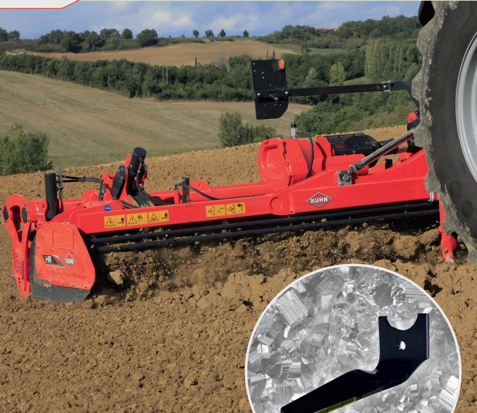
LAME À PLAQUETTES CARBURE DE TUNGSTÈNE,
