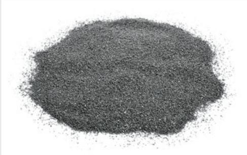
Les plaquettes de carbure de tungstène sont conçues à partir d'un assemblage de poudres obtenues après la compression et la chauffe de plusieurs éléments chimiques dont le tungstène et le carbone. L'ensemble du procédé de fabrication très strict nous permet d'obtenir une matière très dure et très résistante à l'usure.
