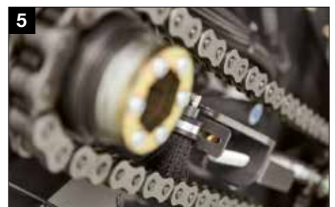
Los cepillos lubricantes anchos y robustos en las cadenas garantizan una lubricación perfecta
