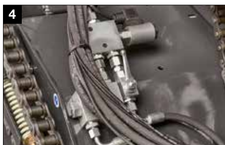
Control independiente de cuchillas / DROPFLOOR desde el terminal de serie
