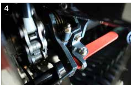
4 Desembrague mecánico del rotor
