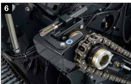
6 Desembrague hidráulico del rotor de serie
