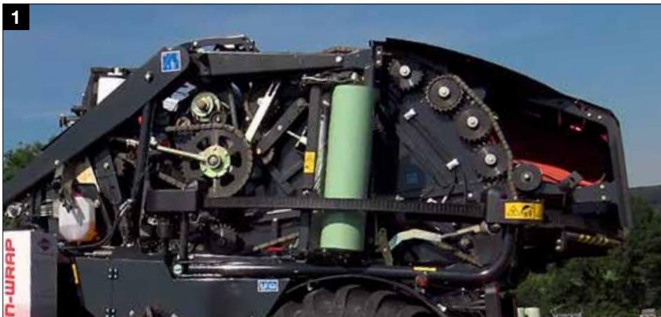
1 Transmisión robusta con cadenas IWIS de alta calidad
