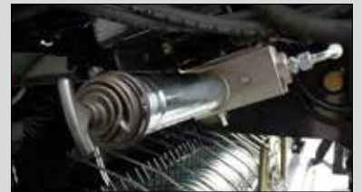
Sistema de lubricación de rodamientos automático Beka Max
