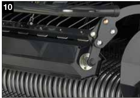
10 Rodillo cosechador de gran tamaño (Ø 217 mm)
