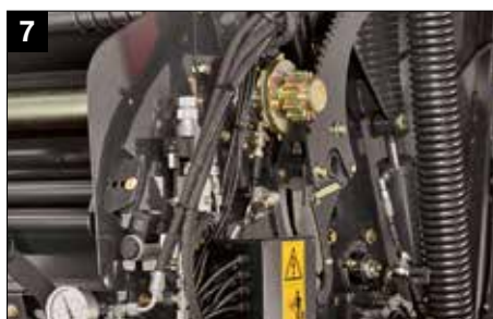
7 Válvula proporcional para control de densidad en el habitáculo
