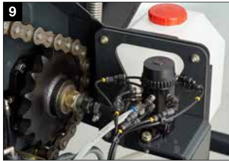
9 Sistema continuo de lubricación de cadenas Beka Max
