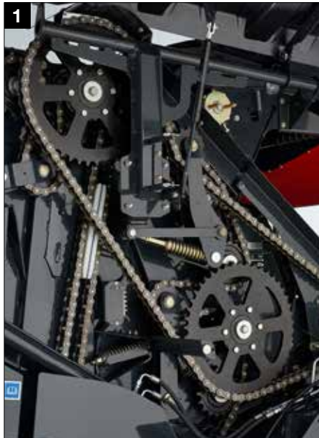
Transmisión robusta con cadenas IWIS de alta calidad
