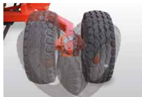
La rueda derecha se pliega hacia el interior para el transporte por carretera. El plegado en el lado izquierdo es opcional
