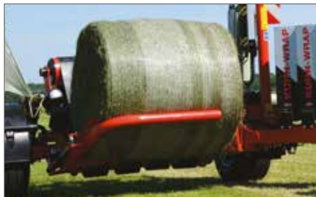
El largo brazo de carga garantiza una carga rápida y suave de la paca
