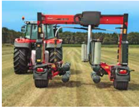
La encintadora se despliega de los 2,5 m de la posición de transporte a los 4 m de anchura para trabajar en el campo
