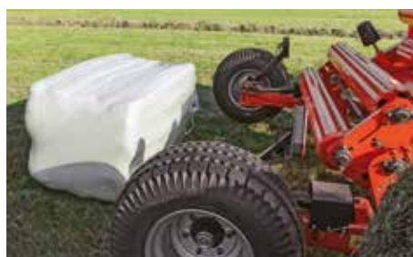
La escasa altura de la mesa permite depositar suavemente la paca para evitar el deterioro del plástico
