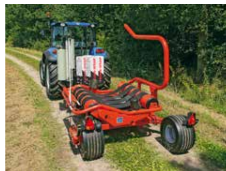
La anchura de transporte es reducida gracias a las ruedas de posición ajustable
