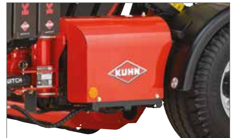
Es fácil acceder a la gran gran cubierta lateral hidráulica para el mantenimiento de la máquina
