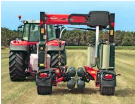
La encintadora se despliega de los 2,5 m de la posición de transporte a los 4 m de anchura para trabajar en el campo
