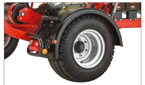
Gracias a unos grandes guardabarros se evita que se dañe el plástico durante el transporte
