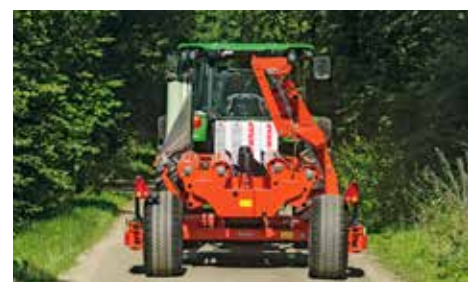
Para el transporte por carretera, las ruedas se pueden plegar hacia dentro a fin de reducir la anchura de transporte. La función de plegado hidráulico es opcional
