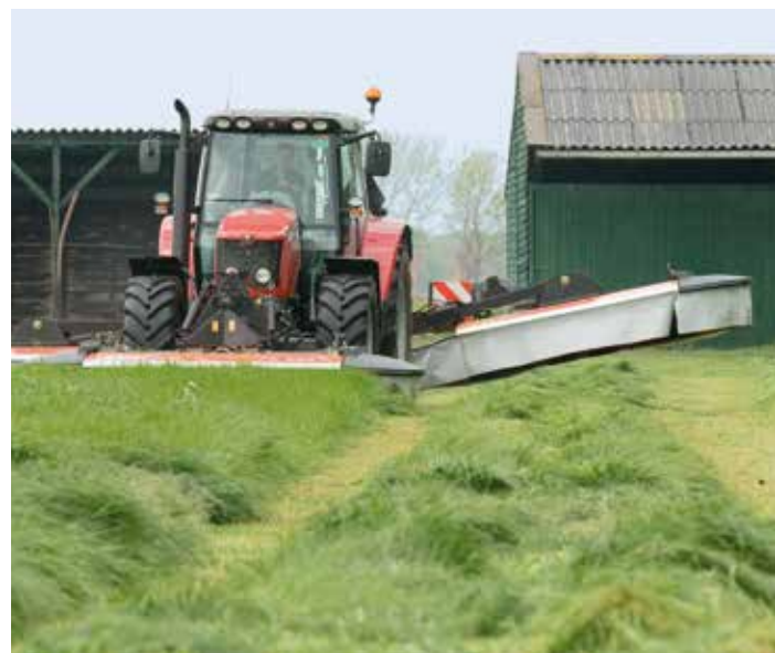
Sollevamento indipendente. La falciatrice a tamburi con combinazione posteriore PZ 960 è munita di serie di una valvola idraulica multifunzione
