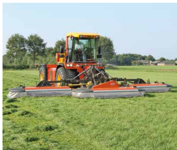
Con regolazioni minime e un kit di attacco per la falciatrice frontale, è possibile utilizzare la falciatrice tripla con trattori a guida retroversa
