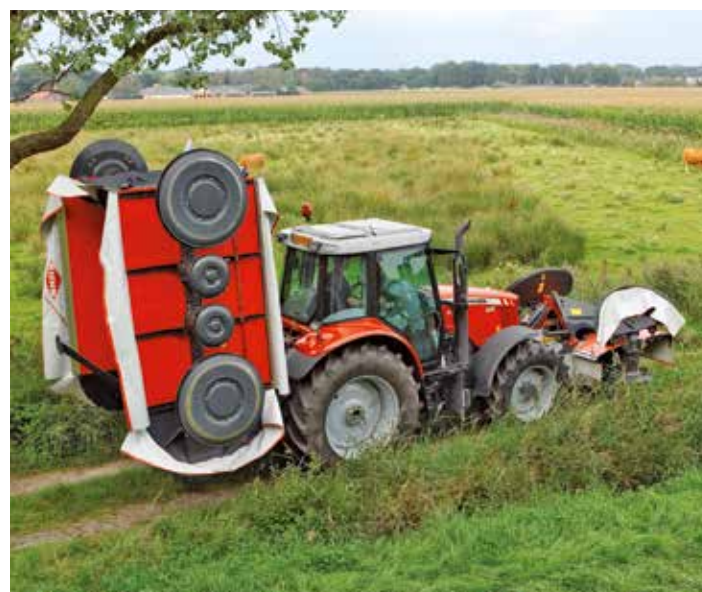
Per una larghezza di trasporto inferiore a 3,00 m, le unità di taglio ruotano verso l'alto grazie a dei cilindri idraulici
