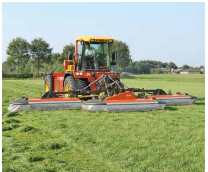
Quelques petits réglages et un attelage spécifique de la faucheuse frontale permettent d'utiliser la faucheuse triple en poste inversé
