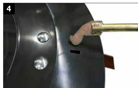
Système de changement des couteaux avec outil spécial et porte-couteaux
