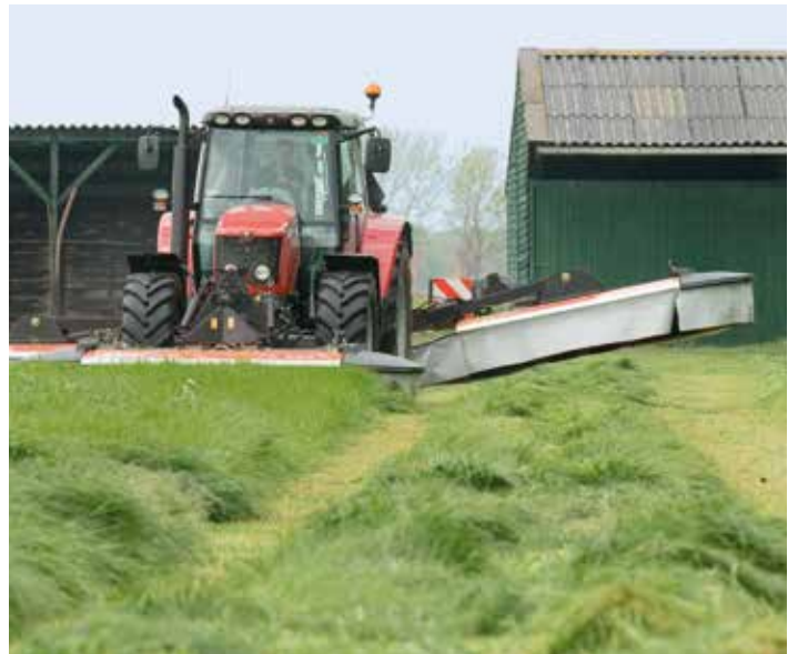
Relevage indépendant. La faucheuse à tambours PZ 960 est dotée, de série, d'une commande hydraulique multifonction
