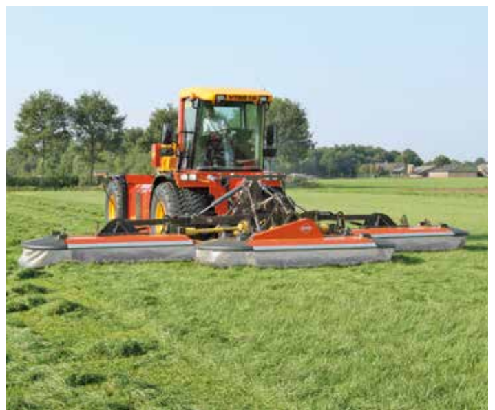
Con unos cuantos ajustes y un kit de acoplamiento para la segadora frontal se puede usar la segadora triple junto con una tracción trasera
