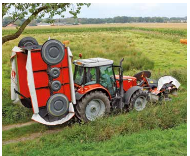
Para una anchura de transporte en carretera inferior a 3,00 m, los grupos de siega se pliegan hacia arriba mediante cilindros hidráulicos
