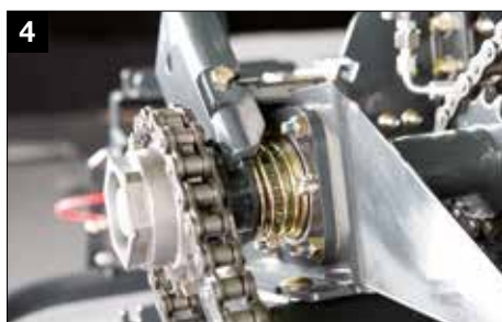
4 Débrayage mécanique du rotor
