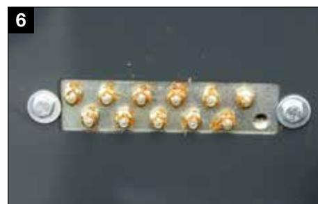
Réservoirs de graisse centraux pour les roulements
