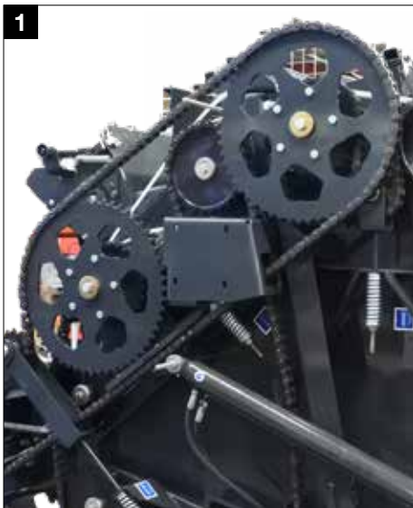
Transmission simple avec seulement 3 chaînes principales
