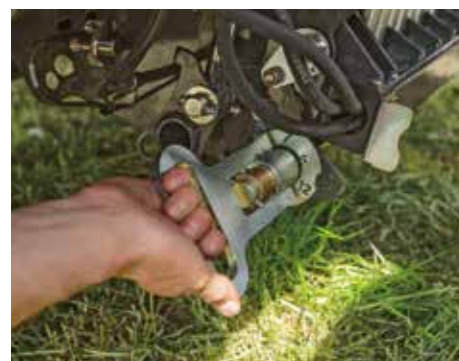
BARILLET ROTATIF POUR LA SÉLECTION DES GROUPES DE COUTEAUX
