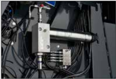
Système de graissage automatique des roulements
