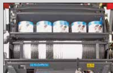
Système de liage mixte par ficelle et filet
