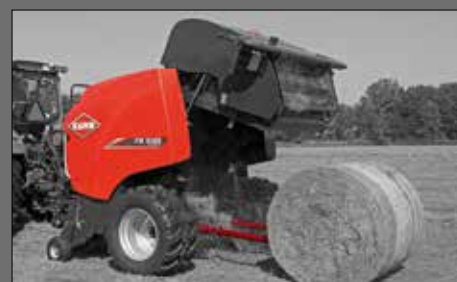
L'éjecteur de balle détecte le moment où la balle est hors de portée. Le hayon ne s'ouvre pas plus que nécessaire. Le hayon se ferme automatiquement
