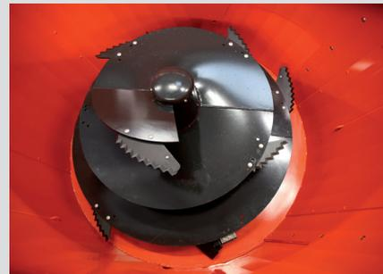
Le mélange est assuré par une vis verticale pour une recoupe rapide des produits fibreux tout en réalisant un mélange aéré avec les rations humides ou semi-humides à base d'ensilages.
