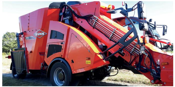
Les modèles SPV ACCESS/POWER/INTENSE sont équipés d'un moteur JDPS à 4 cylindres d'une puissance de 170 ch (126 kW) et ce à 1800 min<sup>-1</sup>. Cette motorisation dite « Constant Speed » est économe et répond aux normes anti-pollution sans avoir la contrainte de l'adjonction d'Ad Blue. Le compartiment moteur est positionné à l'avant de la machine et ce à 90° par rapport à l'avancement.
