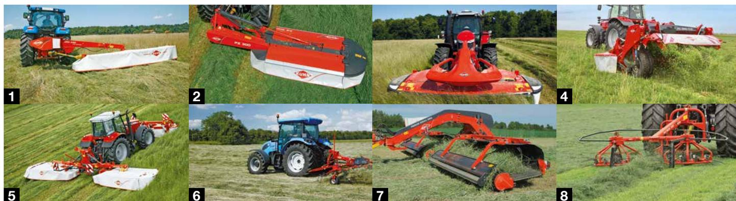
1. Faucheuses à disques arrière - 2. Faucheuses à tambours arrière - 3. Faucheuses et faucheuses-conditionneuses frontales - 4. Faucheuses-conditionneuses à disques arrière - 5. Faucheuses et faucheuses-conditionneuses triples - 6. Giro-Andaineurs - 7. Andaineurs à tapis 8. Faneurs andaineurs
